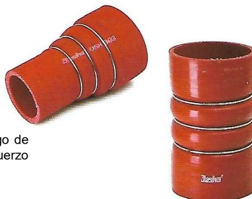
Las mangueras de fuelle pueden ser fabricadas en un rango de longitud de 150 a 300 mm y de 2 a 6 anillos metálicos de refuerzo (3mm de espesor para el refuerzo metálico)
